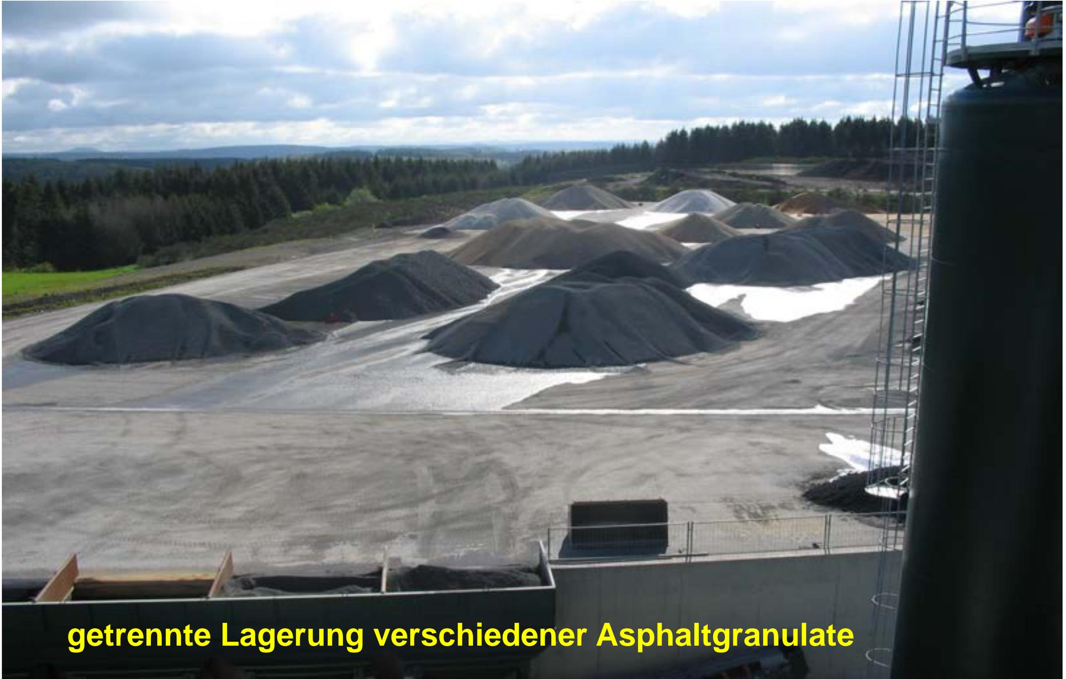
**getrennte Lagerung verschiedener Asphaltgranulate**
